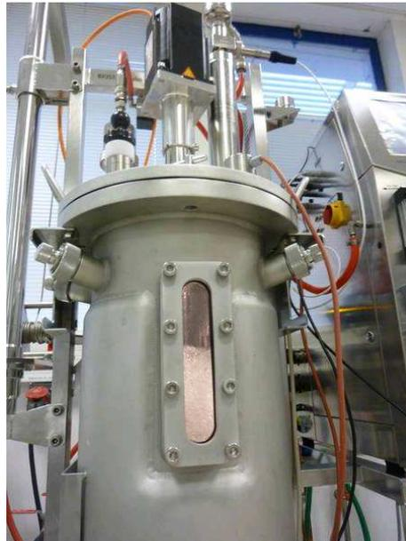
**Le pilote industriel sera doté d'un fermenteur d'une contenance de 500 litres. En laboratoire, les bactéries *E. coli* ont produit avec succès l'isobutène dans une cuve de plus petite taille, soit de 42 litres (voir photographie). © Global Bioenergies**
